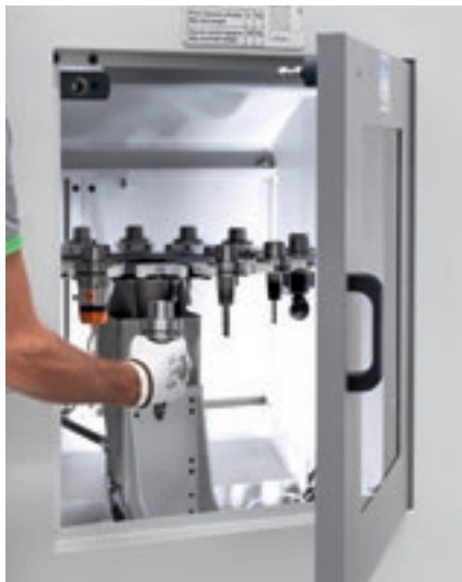
Facilité de chargement des outils grâce à la possibilité d'équiper le magasin par le biais d'une porte d'accès externe, garantissant la plus grande sécurité pour l'opérateur.
